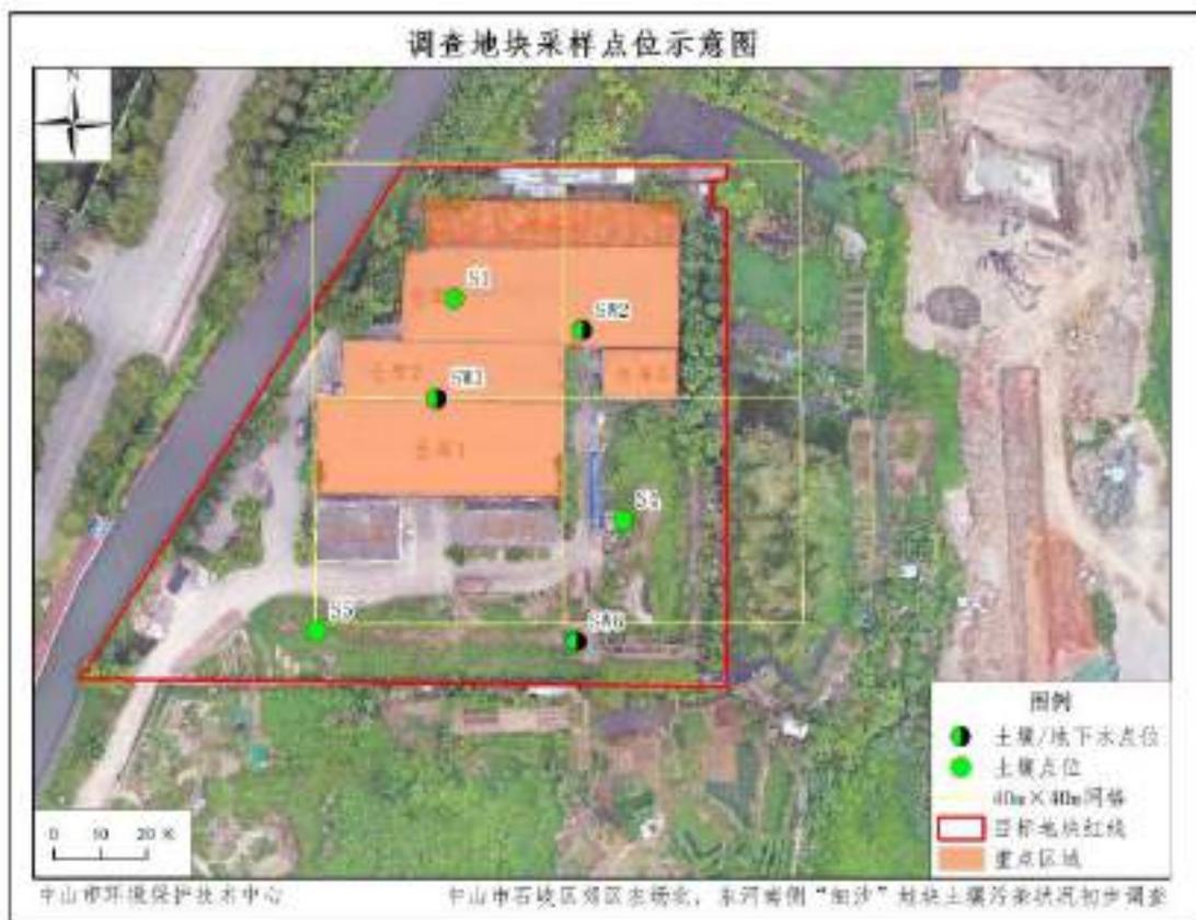
图 5.5-3 原仓库土壤地下水布点图
