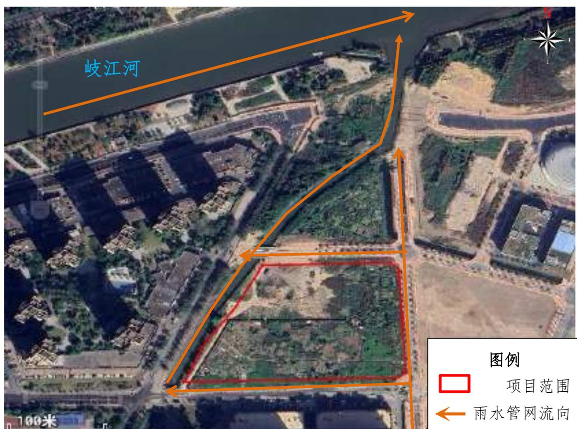
图 5.3-2 地块周边雨水管网流向示意图
