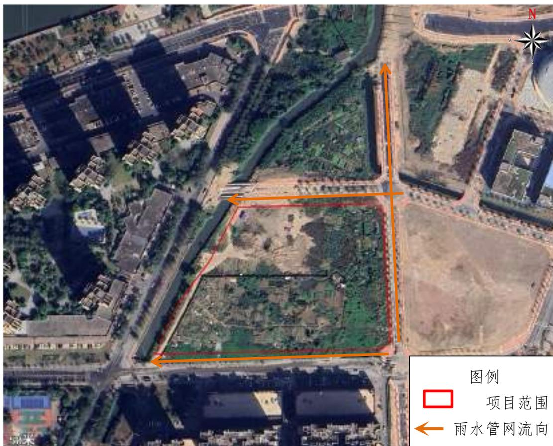
图 5.3-2 地块周边雨水管网流向示意图
