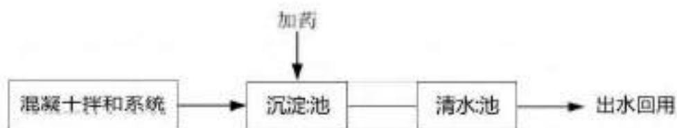
图5.1-3 混凝土拌合系统废水处理工艺流程
