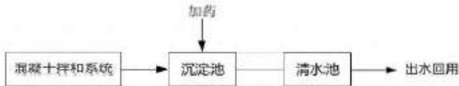
根据调查，本项目混凝土拌合系统废水处理系统正常运行，废水经处理后全部回用于混凝土拌合系统冲洗和地面洒水降尘，没有排放。
