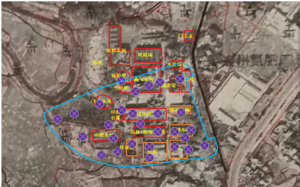
图 4.1-2 土壤采样布点及地下水布点图（历史平面图）
