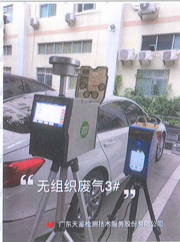
厂界无组织废气下风向检测点3#
