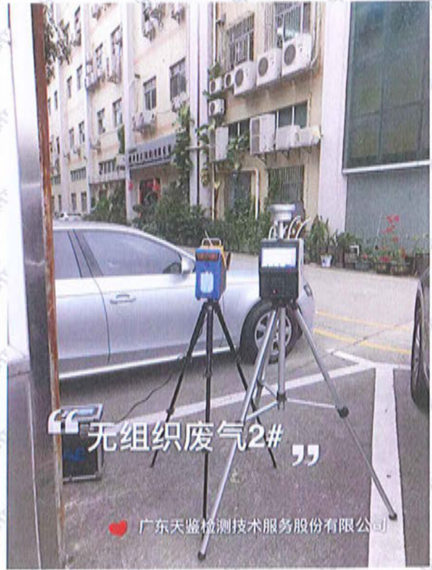
厂界无组织废气下风向检测点 2#
