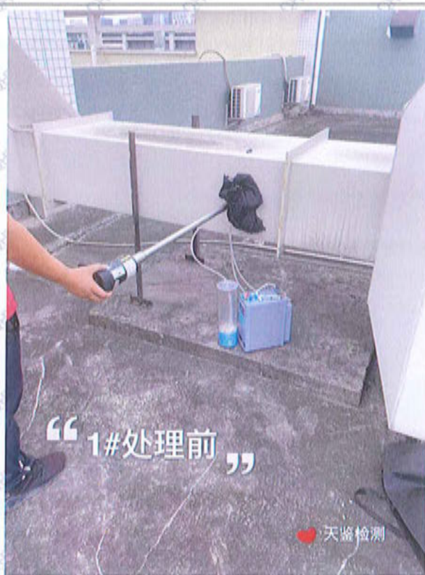
1#排气筒处理前检测口
